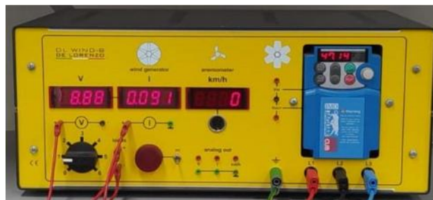
Figura 9. Equipamento para regular a velocidade do vento
