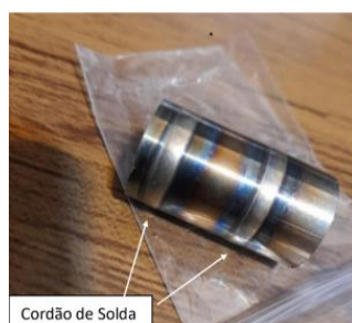
Figura 01. Aço UNS S32707 soldado no sentido transversal do tubo
