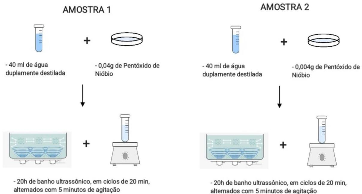
Figura 3. Procedimentos utilizados para a preparação dos nanofluidos de pentóxido de nióbio
