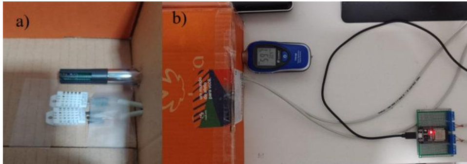
Figura 6 - a) Sensores DHT22 localizados no mesmo espaço do termo-higrômetro TTH100 e b) Vista ampla do espaço de calibração e microcontrolador (Autores, 2025)
