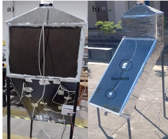
Figura 2 - a) Sensores de temperatura Ds18b20 posicionados na placa absorvedora e b) Sensores Ds18b20 posicionados no vidro (Autores, 2025)
