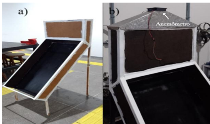
Figura 1 - a) Estrutura com as laterais finalizadas e b) Ênfase na coifa finalizada com o anemômetro posicionado (Autores, 2025)
