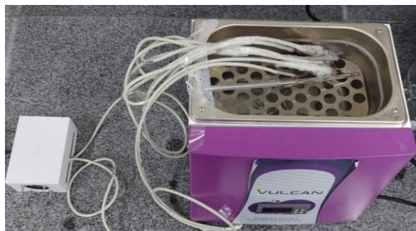
Figura 5 - Calibração dos sensores Dallas DS18B20 (Autores, 2025)
