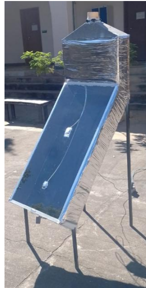
Figura 9 - Chaminé solar finalizada e coletando dados (Autores, 2025)
