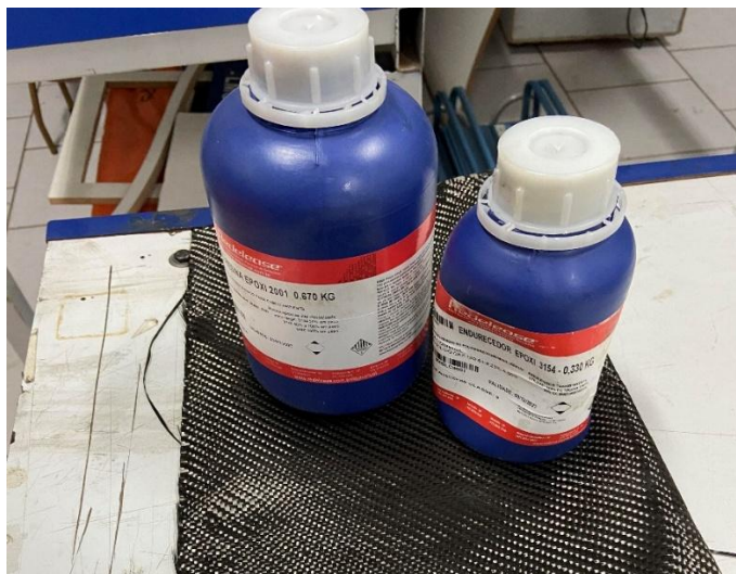
Figura 1. Materiais utilizados no processo de fabricação: fibra de carbono em tecido bidirecional e resina epóxi.
