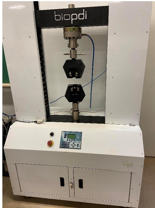
Figura 5. Máquina universal de ensaio utilizada para a realização dos testes de tração nos corpos de prova
