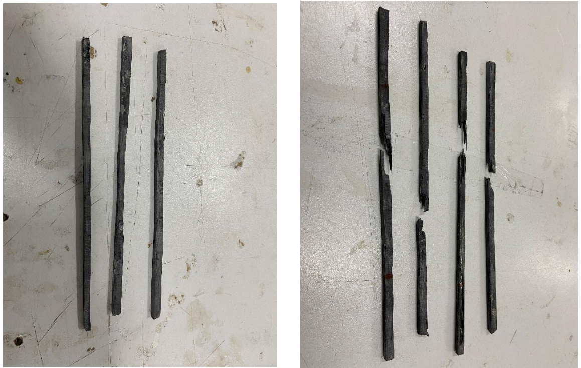
Figura 6. Corpo de prova antes e após o ensaio de tração.
