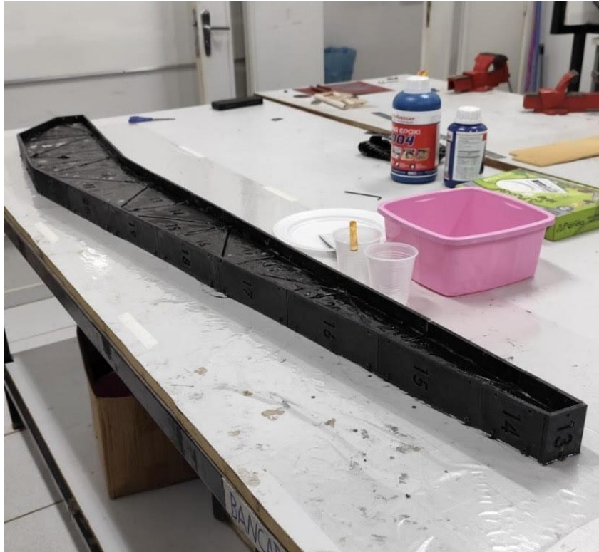
Figura 4. Posicionamento das fibras de carbono sobre o molde antes da aplicação da resina epóxi.
