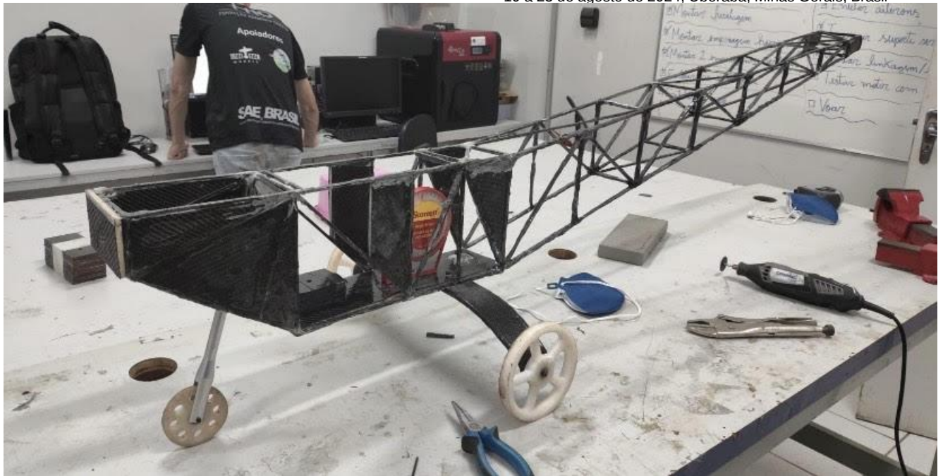
Figura 7. Fuselagem treliçada finalizada, destacando a leveza e complexidade geométrica alcançada com o uso de moldes impressos em 3D.
