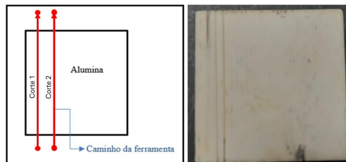
Figura 8. Em a) Planejamento da trajetória do disco. Em b) usinagem realizada pelo disco.
