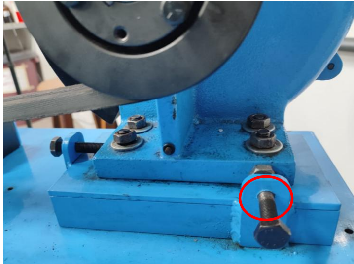
Figura 2 - Pontos de ajustes da base do mancal
