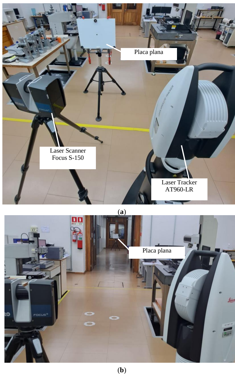
Figura 6. Processo de calibração: (a) Placa plana na posição primária; (b) Placa plana na posição secundária 20 m
