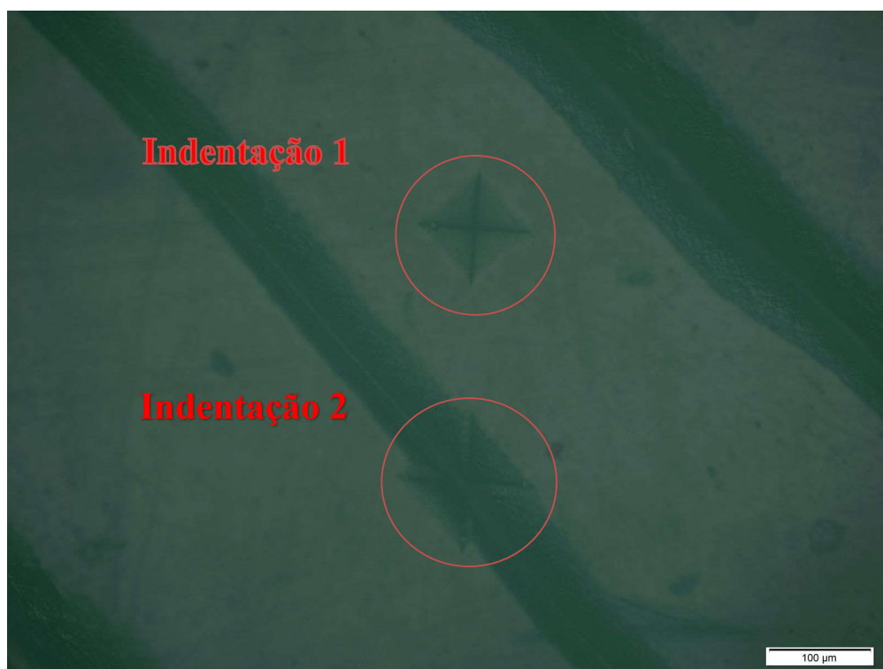
Figura 4. Indentações feitas no corpo de prova. Objetiva de 20x. Imagens em MO
