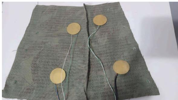
Figura 2: Braçadeira com piezoelétricos.
