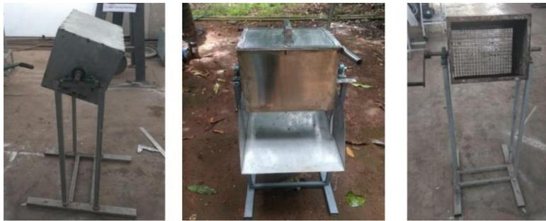
Figura 5. Fermentador de cacau (Aryasree *et al.* 2020)
