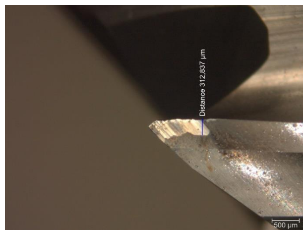
Figura 1 - Desgaste de flanco medido no software ZEN Blue
