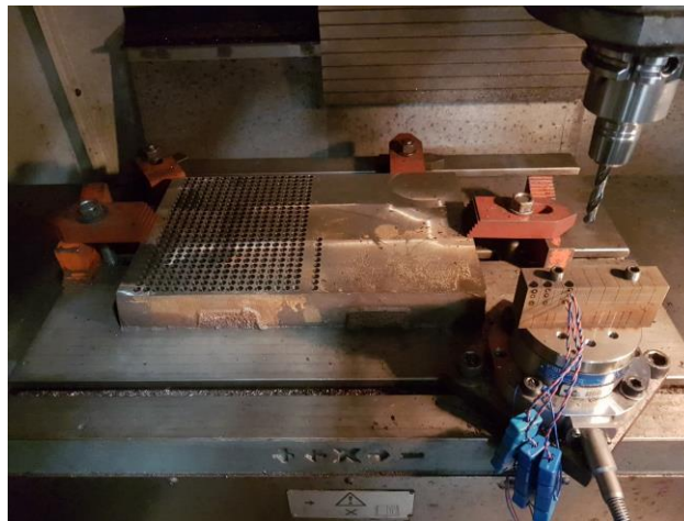
Figura 3. Barras de CGI fixadas na mesa do centro de usinagem.
