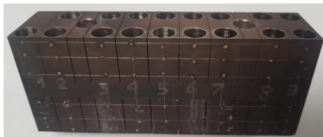
Figura 4. Barra pequena de CGI usada para medição de temperatura.
