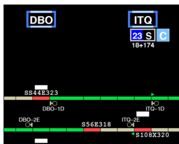
Figura 6. Região supervisionada pelo CCO entre as estações Dom Bosco (DBO) e Itaquera (ITQ), pertencentes a cidade de São Paulo. As composições ferroviárias estão sendo indicadas nos blocos em vermelho
