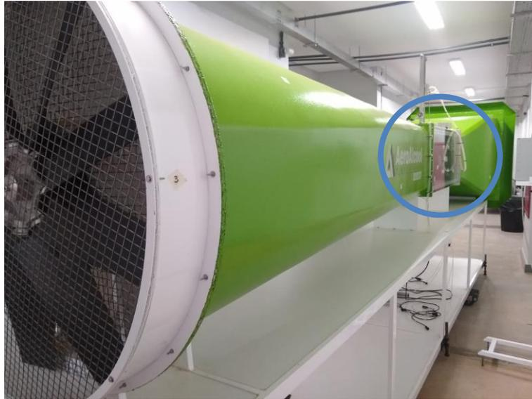
Figura 1 – Túnel de vento AeroAlcool AA-TVSH2.
