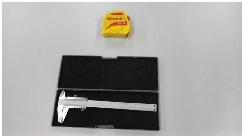
Figura 3 – Trena (na parte superior da imagem) e Paquímetro (na parte inferior da imagem)
