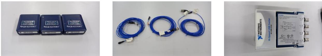
Figura 5 – Caixa dos acelerômetros, cabo coaxial BNC e placa de aquisição de sinal.
