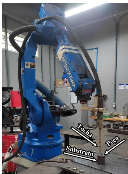
Figura 1. Manipulador robótico utilizado para a MADA com FCAW
