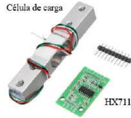
Figura 5. Célula de carga e Módulo HX711
