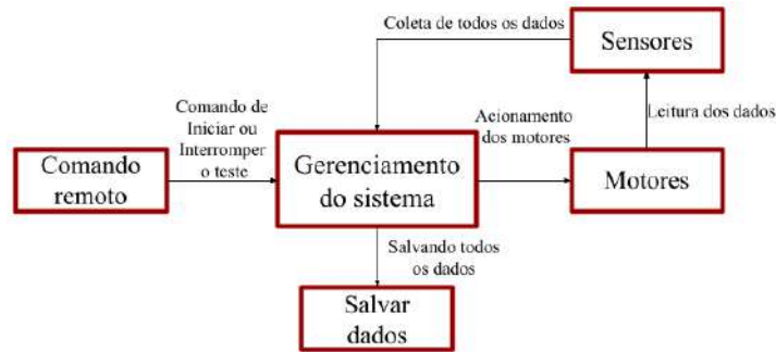
Figura 3. Diagrama de integração do sistema de coleta dos dados
