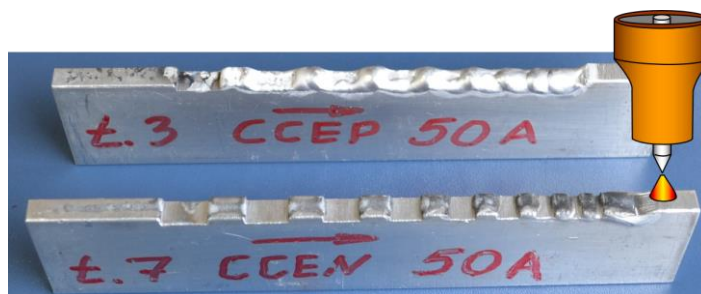
Figura 2.1. Barras de alumínio submetidas à ação do arco do processo TIG nas mesmas condições de soldagem, mas em polaridades diferentes CCEN e CCEP
