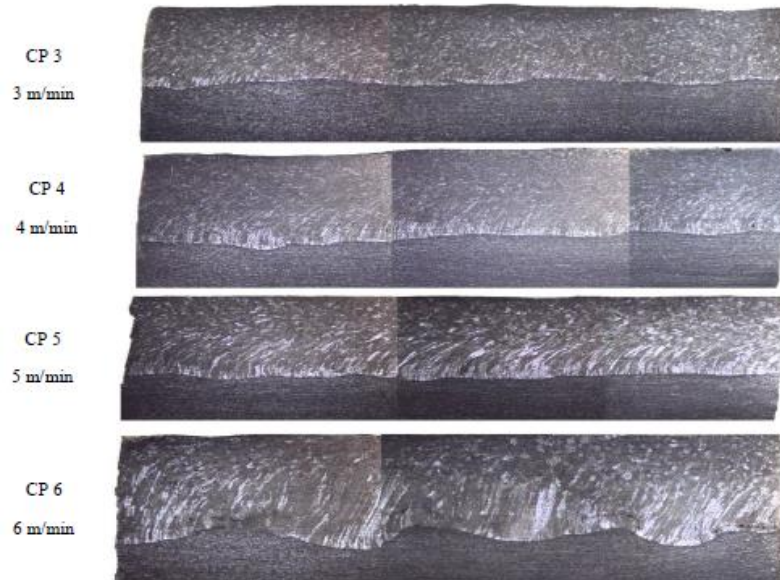
Figura 5. Seções longitudinais dos cordões CP 3, 4, 5 e 6 com ampliação de 8x. (Autoria propria,2019)
