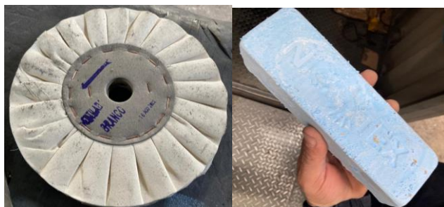
Figura 2. Pano ventilado utilizado (esquerda) e massa de polir (direita) utilizados no processo de polimento.
