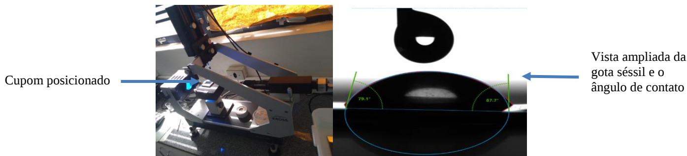
Figura 4. Amostra posicionada no goniômetro para averiguação do ângulo de contato da gota sésil com o material.
