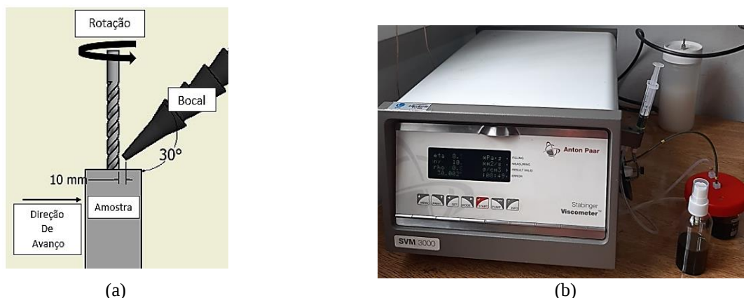
Figura 1. Montagem experimental para os ensaios pela técnica MQF no microfresamento (a) e o viscosímetro Modelo Stabinger™ SVM™ 3000 (b).
