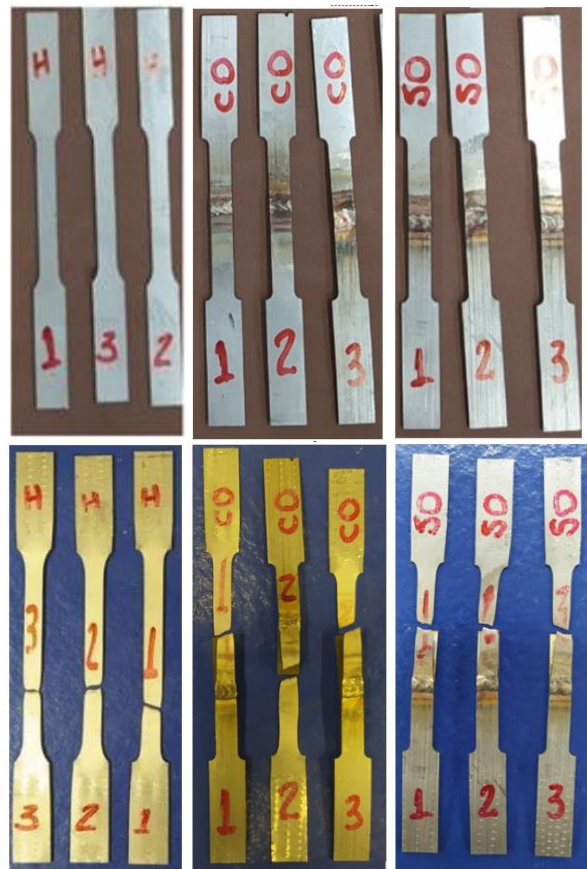
Figura 8 - Amostra de Metal Base (MB), chapa soldada com overlap (CSCO) e chapa soldada sem overlap (CSSO), antes e depois do ensaio de tração (Autor, 2022).
