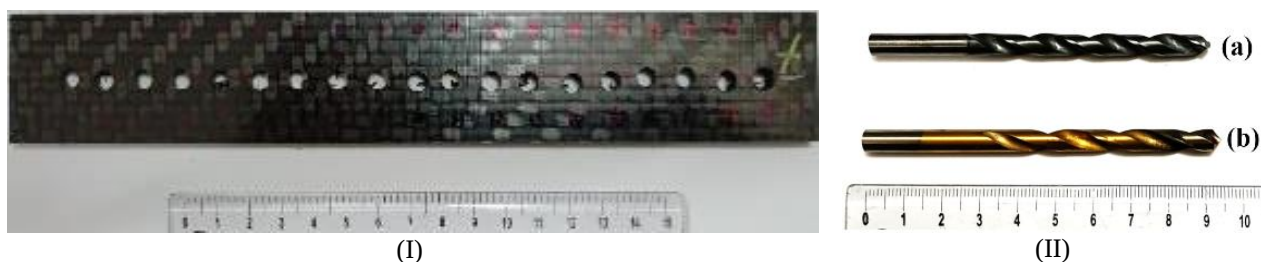
Figura 1. I - Corpo de prova de CETEX TC910 T7000SC-12K. II - (a) Broca de Metal Duro revestido de TiAlN; (b) Broca de Aço Rápido revestida de TiN.
