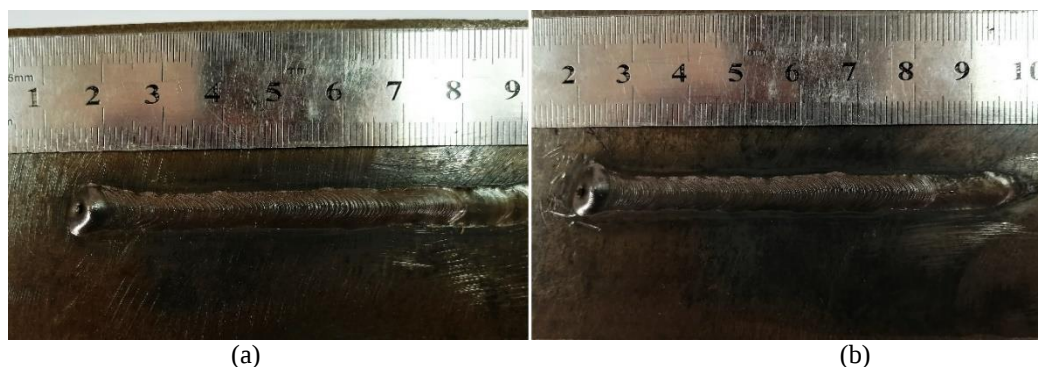
Figura 11. Aspecto superficial (a) Velocidade de soldagem ( V_s ) de 30 cm/min. Velocidade de arame ( V_a ) de 2,5 m/min. (b) Aspecto superficial (a) Velocidade de soldagem ( V_s ) de 30cm/min. Velocidade de arame ( V_a ) de 4,0 m/min.
