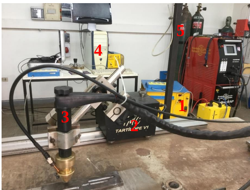
Figura 1. Banco de ensaios para o processo de soldagem TIG com adição mecanizada de arame. 1) Fonte de soldagem. 2) Sistema de deslocamento da tocha. 3) Tocha TIG adaptada. 4) Sistema de aquisição de dados. 5) Gases de proteção.
