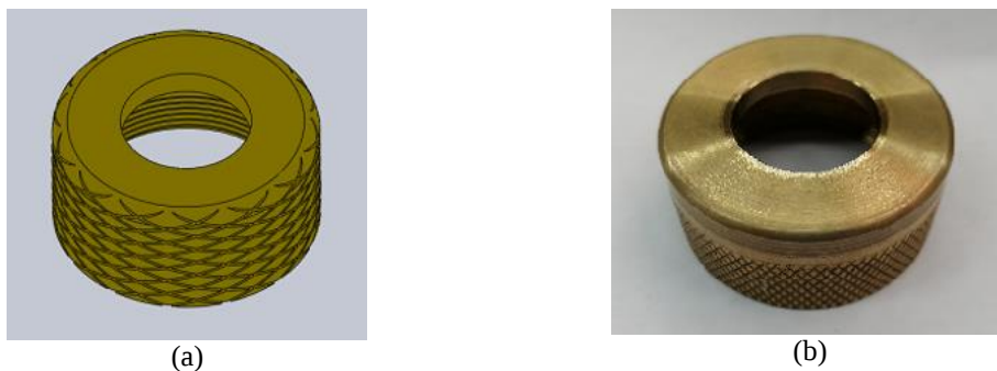
Figura 6. (a) Suporte do bocal projetado. (b) Suporte do bocal fabricado de bronze.
