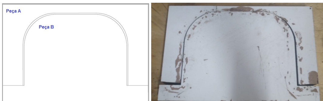
Figura 9. Desenho do molde projetado em SolidWorks evidenciando as partes que o compõem e molde cortado.
