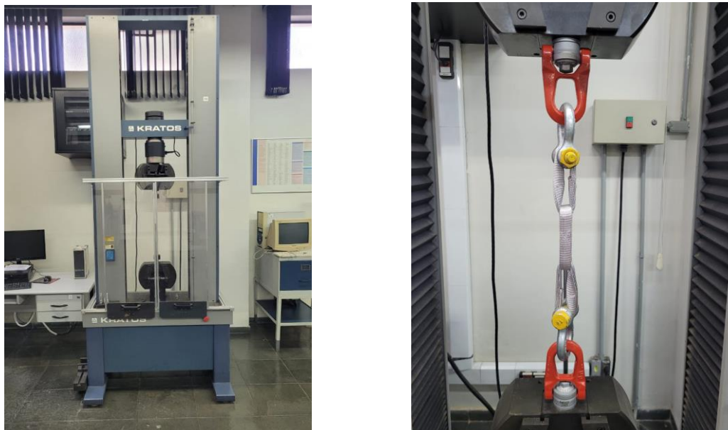
Figura 3. Máquina de ensaio utilizada e a forma de acoplamento da corrente (direita) (Elaborado pelo autor)
