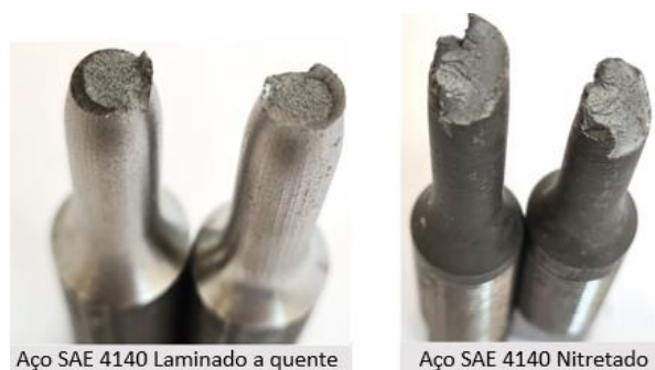
Figura 7: Fratura dos corpos de prova na tração
