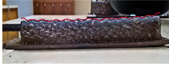
Figura 9. Deposição de solda para 20 camadas sobrepostas, utilizando V_a=2.2 m/min e V_s=9 mm/s em uma geometria retangular
