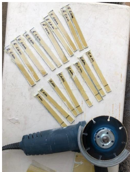
Figura 2. Corpos de provas após o corte com a esmerilhadeira. (Autor, 2022.)
