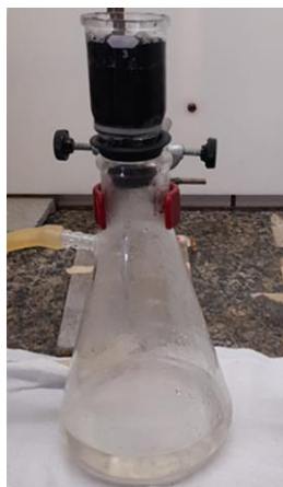
Figura 1. Lavagem das fibras micrométricas de carbono
