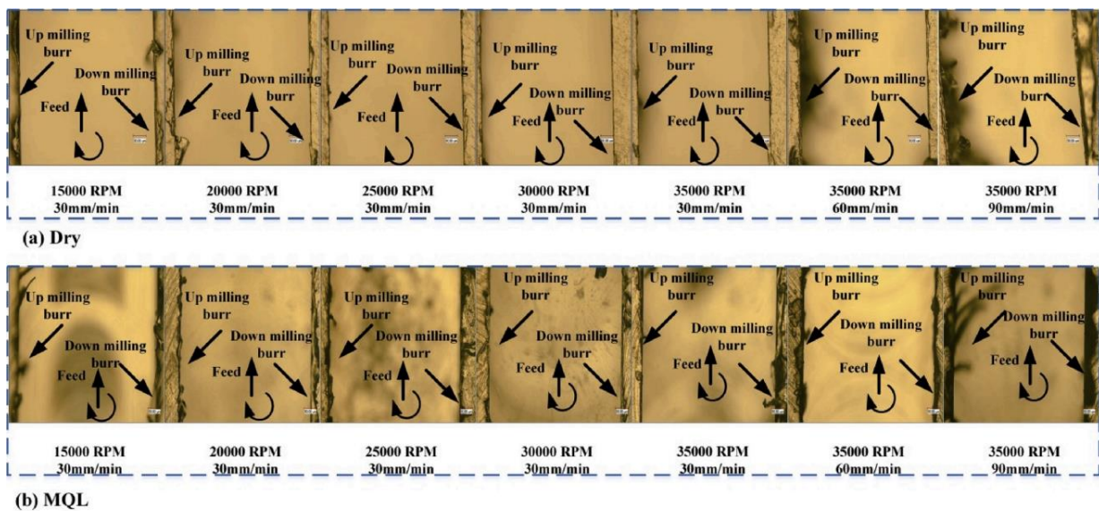
Figura 6. Formação de rebarba com diferentes parâmetros e utilizando o (a) corte a seco e (b) MQL (KHALIQ et al, 2020)
