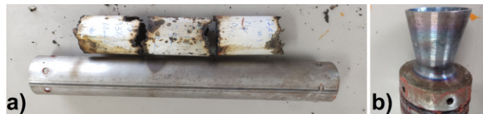
Figura 18. Casing com inibidores (a) e tubeira (b) após o funcionamento do motor
