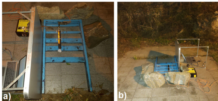
Figura 10. Visão traseira do Motor-foguete montado na base de testes (a) e visão frontal do motor-foguete montado na base de testes (b)
