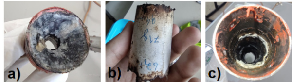
Figura 17. Interior da tubeira após a queima (a); Inibidor após a queima (b); Interior da casing após a queima contendo resíduos da combustão do propelente e vestígios de silicone para alta temperatura (c)
