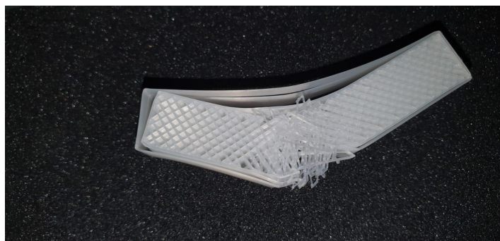
Figura 4. Corpo de prova ensaiado no método Charpy martelo 450 J. (Do autor, 2022)
