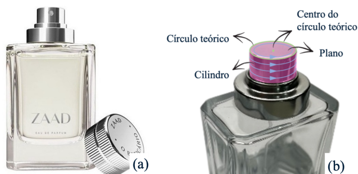
Figura 1. (a) Frasco utilizado na realização dos ensaios. (b) Elementos geométricos avaliados
