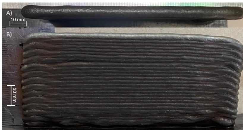
Figura 7. Parede obtida com controle de temperatura por interpasse entre 45°C e 55°C
