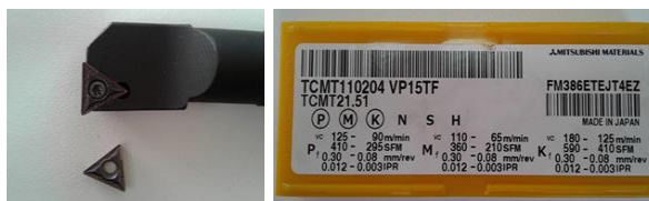
Figura 2. Porta ferramenta e pastilha para torneamento utilizados neste trabalho.
