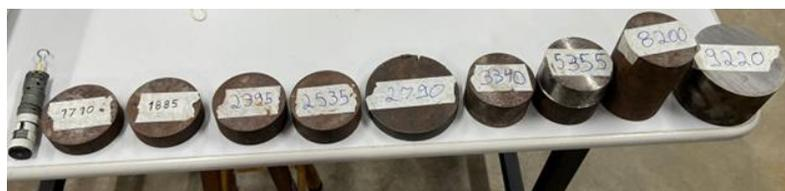
Figura 3. Massas utilizadas na pesagem
