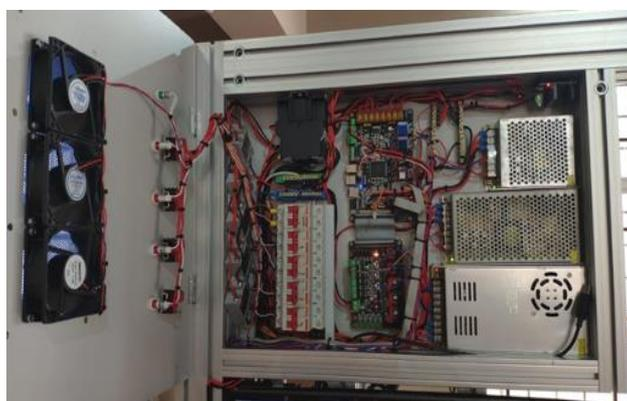
Figura 6. Sistema de comando da impressora de grande porte. (Autores, 2021).
