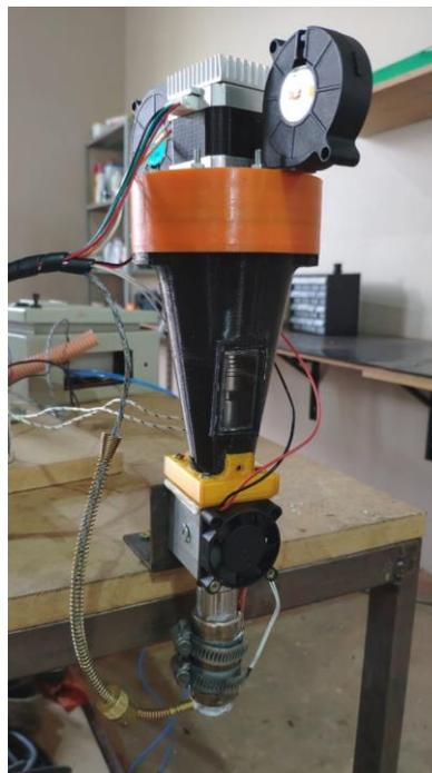
Figura 8. Extrusora de pellets. (Autores, 2022).
