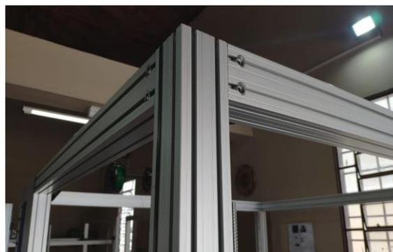
Figura 5. Detalhe dos perfis 80x80, utilizados na versão final do equipamento. (Autores, 2020).
