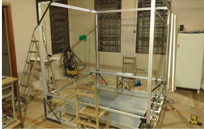
Figura 1. Estrutura de suporte com as guias de deslocamento e mesa de impressão já montada. (Autores, 2020).
