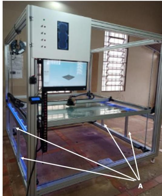
Figura 4. Visão frontal da nova impressora. A: Suporte para elevação da mesa de aquecimento. (Autores, 2020).
