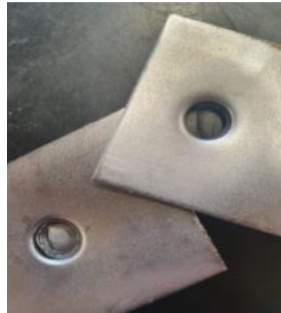
Figura 18. Amostra do Clinching ampliada após a ruptura.
