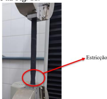
Figura 11. Momento onde ocorre a estricção no corpo de prova (Fonte: Autores)
