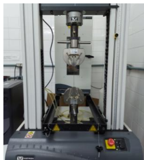
Figura 6. INSTRON 3367 com a célula de carga de 30 N (Fonte: Autores)
