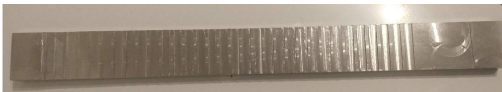
Figura 3. (a) . Corpo de prova (Ti-6Al-4V) com ensaios executados. (Dados do autor, 2022)
