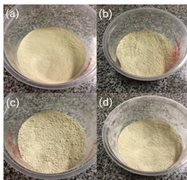
Figura 1. Materiais Utilizados como reforços: (a) 90\ \mu\text{m} - 180\ \mu\text{m} ; (b) 53\ \mu\text{m} - 90\ \mu\text{m} ; (c) <53\ \mu\text{m} (rejeito); (d) Calcário como adquirido (Autoria Própria, 2020).
