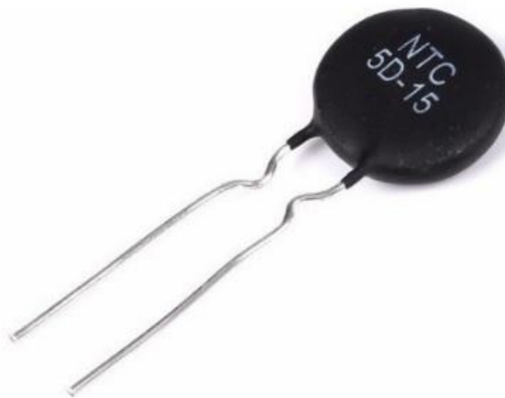
Figura 6. Exemplo típico de um termístor.
