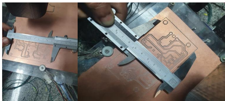
Figura 8. Medição das dimensões de gravação feita na máquina CNC para análise de eficiência
