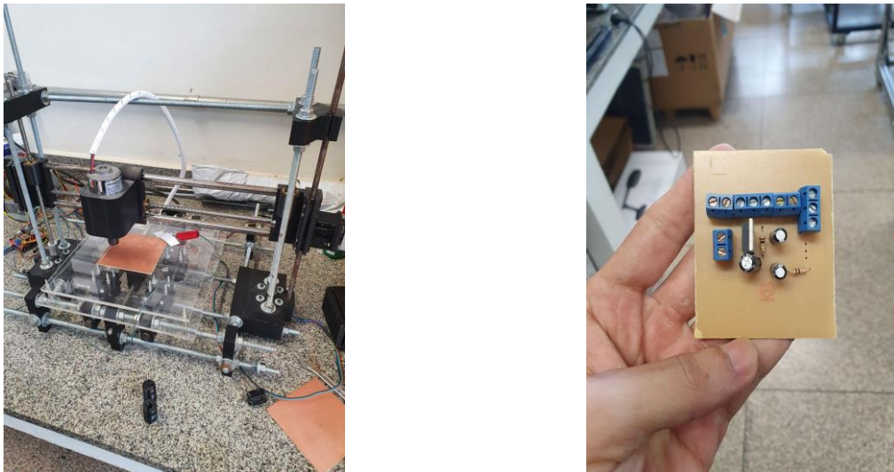
Figura 6. Máquina CNC para PCI desenvolvida (esquerda) e placa de Circuito impresso desenvolvida e soldado os componentes (direita)
