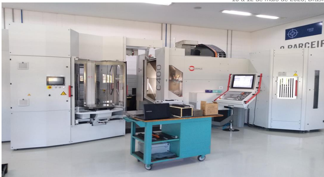
Figura 1. Centro de usinagem Hermle C400 utilizado para os testes de furação
