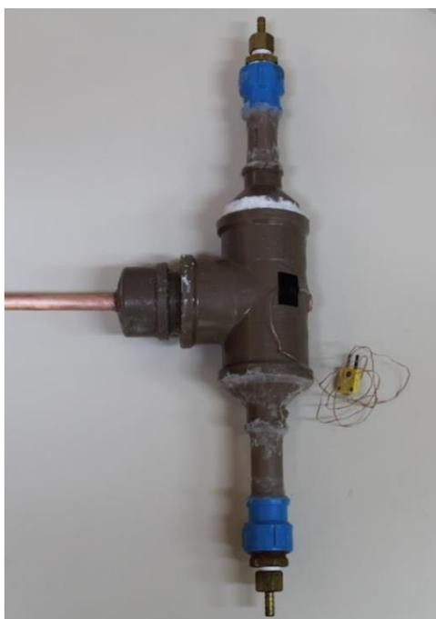
Figura 3. Sistema de circulação de água no condensador (Autoria Própria).
