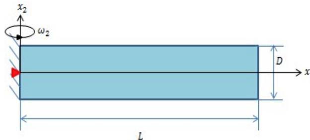
Figura 1. Barra esbelta horizontal com força centrífuga.
