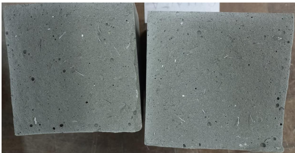
Figura 4. Face rompida do traço 2 de UHPC
