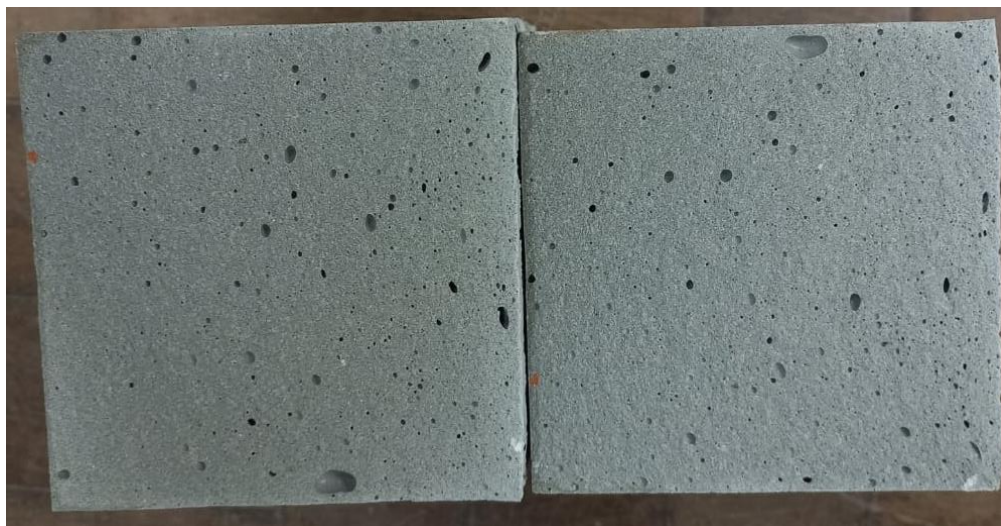
Figura 5. Face rompida do traço 3 de UHPC
