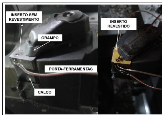
Figura 3. Posicionamento dos termopares na ferramenta de corte.
