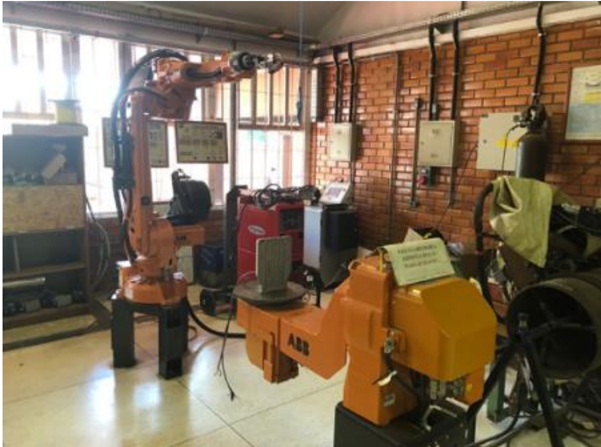
Figura 2. Célula de manufatura aditiva instalada no laboratório GRACO da UnB, composta pelo robô ABB IRB 2600 e mesa posicionadora robótica ABB IRBP A250 (De autoria própria)
